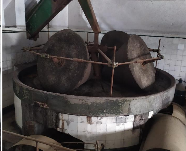
Figura 20 - Moinho de pedra de lagar tradicional, Custódio Alves Fábrica de Azeites, Montemor-o-Novo (foto próprio 03/10/2021).
