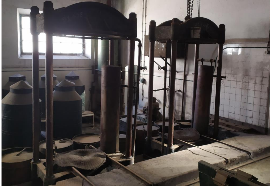
Figura 22 – Prensas hidráulicas para extração de azeite em lagar tradicional, Custódio Alves Fábrica de Azeites, Montemor-o-Novo, (foto próprio 03/10/2021).
