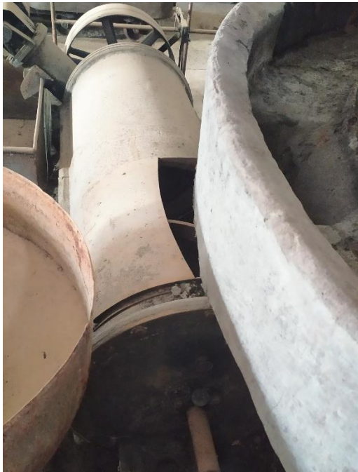
Figura 16 – Batedeira de lagar tradicional, Custódio Alves Fábrica de Azeites, Montemor-o-Novo (foto próprio 03/10/2021).
