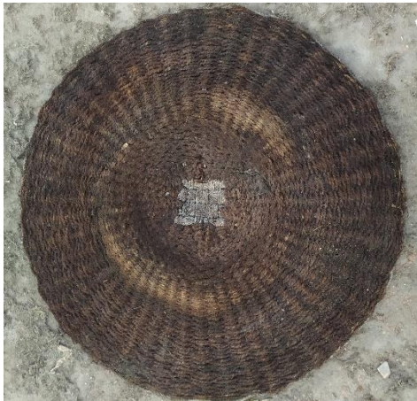
Figura 21 - “Capacho”, diafragmas de fibra para extração de azeite em lagar tradicional, Custódio Alves Fábrica de Azeites, Montemor-o-Novo, (foto próprio 03/10/2021).
