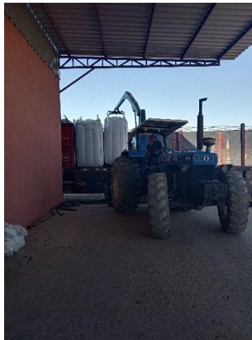
Figura 53 - Grua acoplada a trator utilizada para carregar Big Bags no camião de transporte
