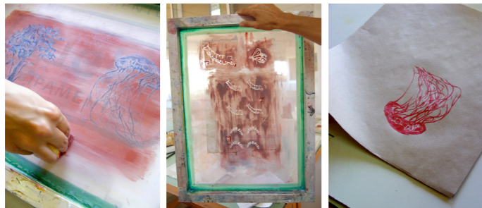
Exemplo de impressão através do método directo com o “screen drawing fluid”
