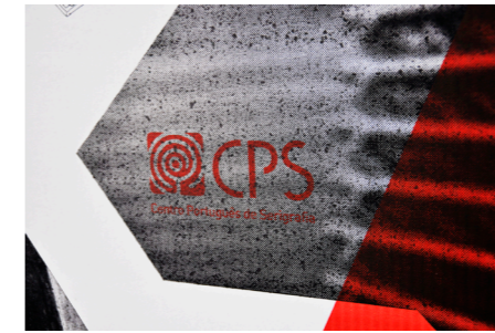
Figura 178 | Exemplo de uma impressão com excesso de água na tinta.
