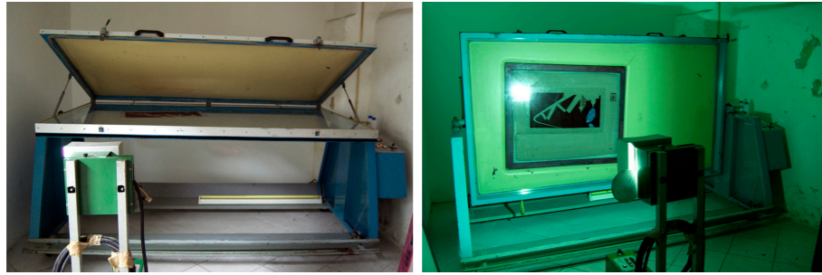
Figura 72 | Caixa de luz e exposição do quadro à luz UV, CPS. (Arquivo pessoal)
