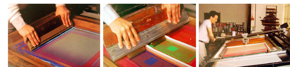
Figura 48, 49 e 50 | Exemplo de um distribuidor manual, ajustável e fixo. (Faine, 1990:28)
