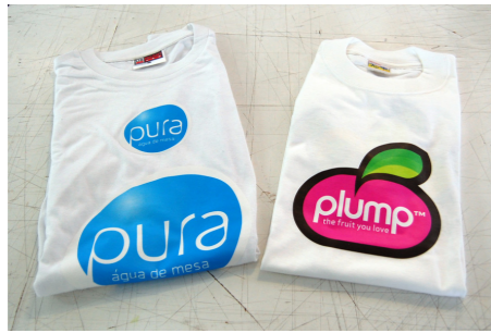
Figura 101 | Impressão serigráfica primeiramente sobre papel transfer e estampado a quente sobre o tecido. T-shirts pura: 3 cores (azul, magenta e branco); t-shirt plump: 5 cores (cmyk + branco). (Arquivo pessoal)
