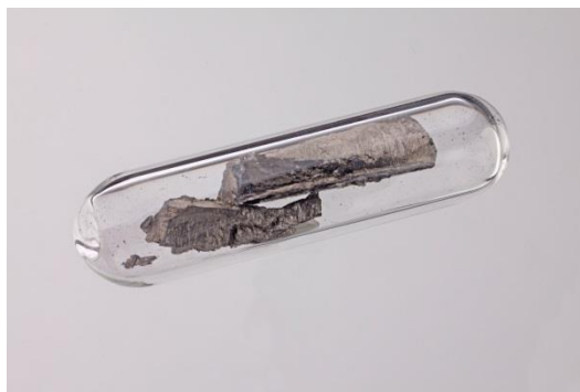
Figura 2 Neodímio metálico. A ampola tem cerca de 6 cm de comprimento. Foto e exemplar do autor
