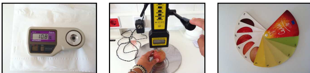
Figura 17, 18 e 19 - Refratómetro digital, Penetrómetro de bancada digital e carta de cores maçã 'Gala'
