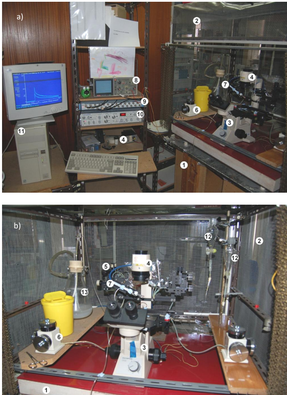
Figura 3.1- Setup de patch-clamp. a) vista geral; b) pormenor do setup de patch-clamp colocado sobre a mesa anti-vibratória. 1- mesa anti-vibratória, 2- gaiola de Faraday, 3- microscópio invertido, 4- fonte de iluminação, 5- manipulador, 6- manipulador hidráulico, 7- pré-amplificador, 8- osciloscópio, 9- interface de conversão A/D, 10- electrómetro, 11- computador, 12- sistema de perfusão, 13- recipiente colector integrante do sistema de vácuo.
