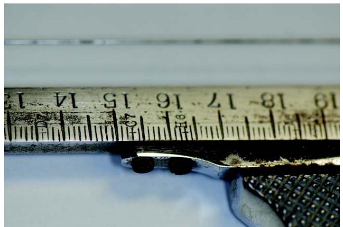
Fig 70 - O Monocórdio de Struycken - Instrumento concebido pelo médico holandês Hubert Struycken (1869-1950) em que fazia vibrar um corda metálica e se fazia variar a frequência utilizando um cursor e uma escala. É impressionante a minúcia e precisão deste instrumento
