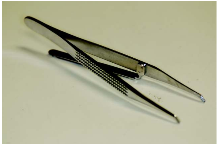
Fig 59 - A pinça é um instrumento muito antigo e quase que prolonga a acção dos dedos. As inúmeras variações que se encontram no mundo das pinças ilustram a procura permanente de criar instrumentos que consigam desempenhar o objectivo pretendido da melhor forma. Os comprimentos, o angulo da abertura, o tamanho e forma da extremidade, a força necessária, a redução do traumatismo, a forma como se manipula, o fim a que se destina, onde vai ser utilizada são factores que encontramos quando se observa um catálogo de instrumentos cirúrgicos. Apesar de ser um instrumento tão simples, utilizado há séculos, a sua evolução continua.
