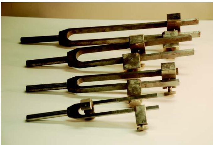
Fig 66 - Os diapasões começaram a ser usados pelos maestros e músicos . Depois passou a ser usado para avaliar a audição. Da informação dos diapasões nasce a avaliação audiológica e toda a Audiologia actual. Medir a audição nas varias frequencias já era preocupação que os nossos antecessores procuraram resolver das formas mais engenhosas. Diapasões de varios tamanhos , com cursores com escalas, que se tornassem funcionais para a clínica levaram a muitas experiências e soluções.
