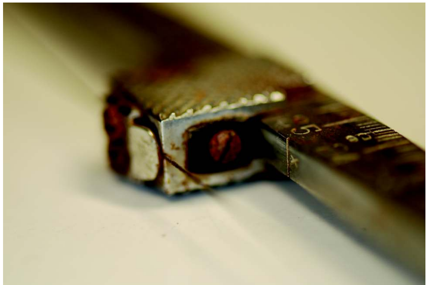
Fig 72 - O Monocórdio de Sruycken - pormenor da forma como o cursor e a corda metálica estão interligados
