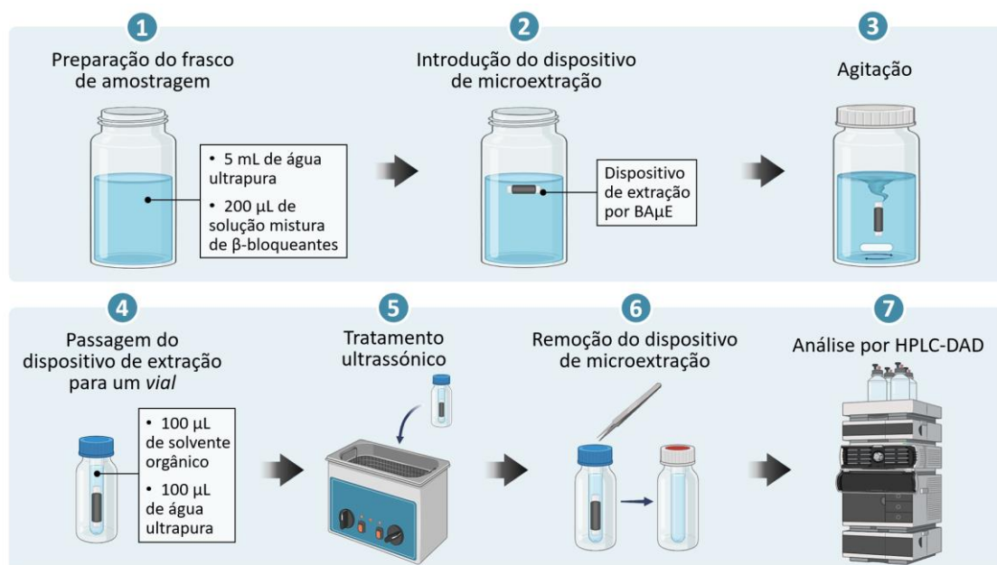
Figura 2.1 - Ilustração esquemática do procedimento experimental para otimização, incluindo as etapas de microextração, retroextração e análise instrumental.
