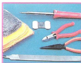
SOLDAGEM Foto 1 - Para que se realize uma boa soldagem, é indispensável possuir o material básico acima ilustrado na foto.
