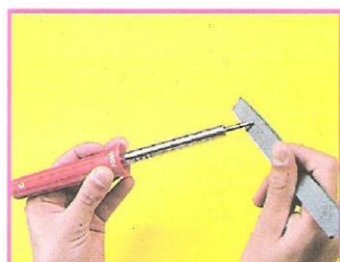
Foto 4 - Para evitar pequenos acidentes, procure segurar o soldador e a lima com segurança e firmeza; não faça como mostra a foto.
