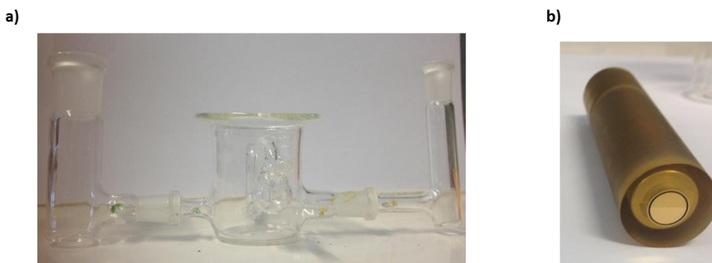
Figura 2.14 - a) Célula eletroquímica de 3 compartimentos e b) eletrodo de Au policristalino.
