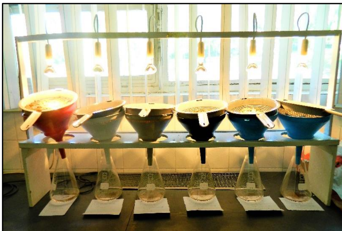
Figura 19 – Instalação do funil de Berlese-Tüllgren na ESA (Escola Superior Agrária) para extração da fauna do solo. Fonte: Fotografia do autor.
