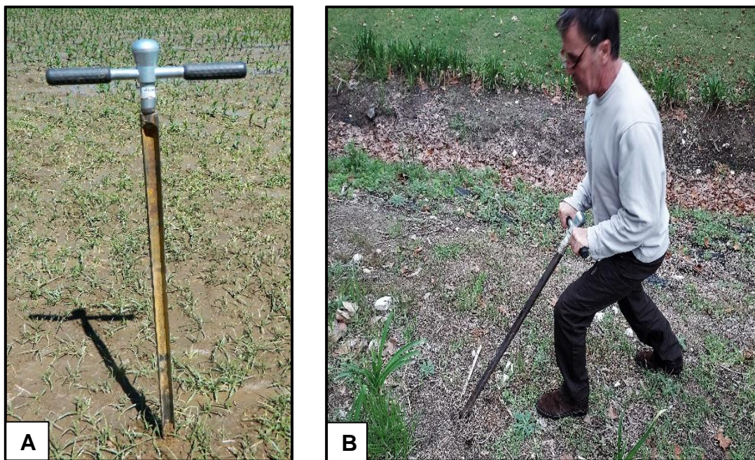
Figura 18 – A – Perfil da sonda de solo usada na amostragem Fonte: Fotografia do autor. / B – recolha da amostra Fonte: Fotografia de Pedro Cotta.
