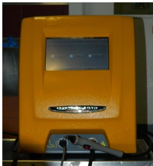
Figura 6 - Dispositivo gerador de pulsos elétricos utilizado, ELECTROvet® S13 (LEROY biotech).
