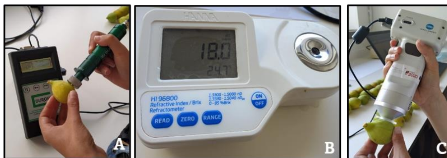
Figura 19. Medição da firmeza com o Durofel (A); Refratômetro de bancada (B); Colorímetro (C).
