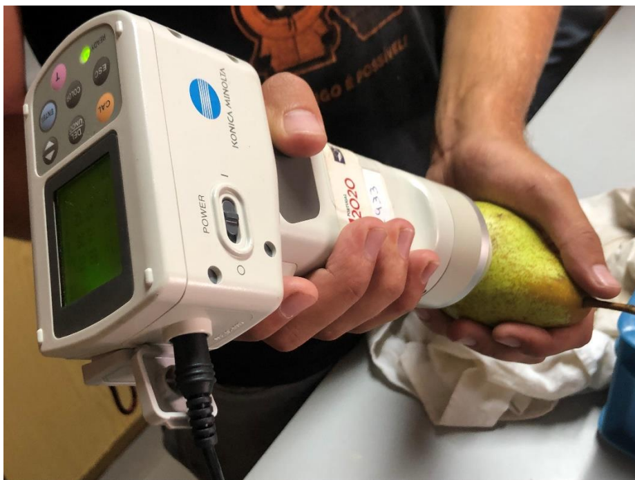
Figura A3 - Exemplo da metodologia utilizada na quantificação da cor dos frutos: medição de dados com recurso a colorímetro (Konica Minolta, modelo CR-400, Japão)
