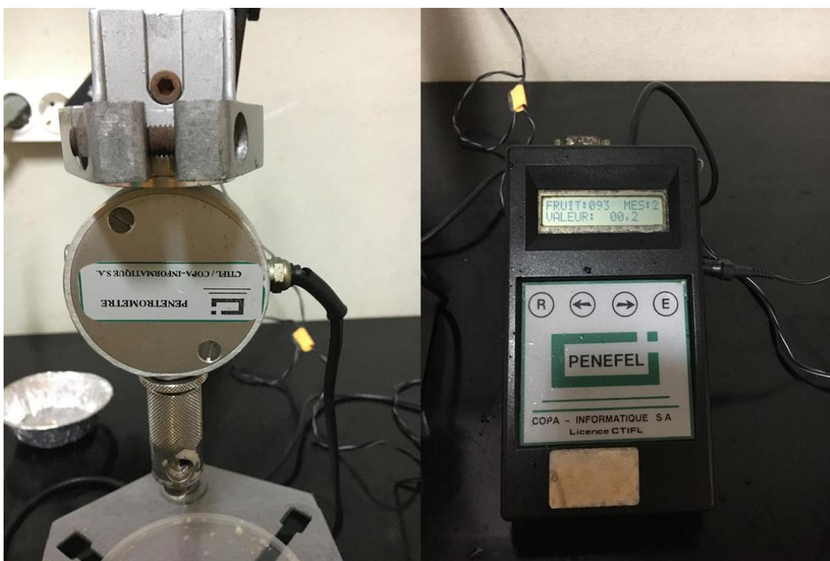
Figura A4 - Penetrómetro digital (Agro-Technologie mod. Penefel DFT 14) utilizado na quantificação da dureza dos frutos
