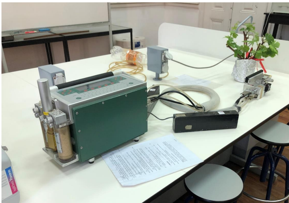
Figura A5 - Aparelho (Licor 6400) utilizado para as medições de fotossíntese líquida e condutância estomática
