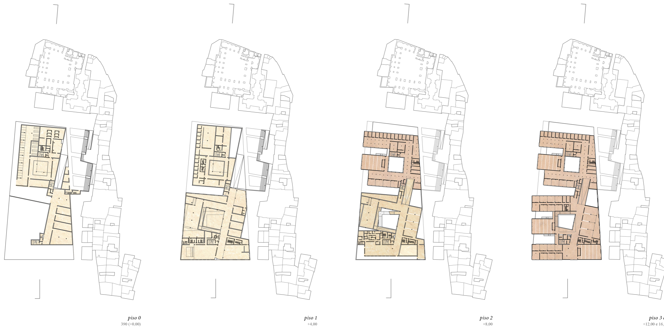
Fig.64 | Plantas da proposta arquitectónica. A escola desenvolve-se em quatro pisos; persistindo um desnível entre o núcleo privado - a Norte - e o público - a Sul. A amarelo assinalam-se as áreas de serviços e a castanho, as áreas de aulas. [Desenho da autora. Escala 1:2000]
