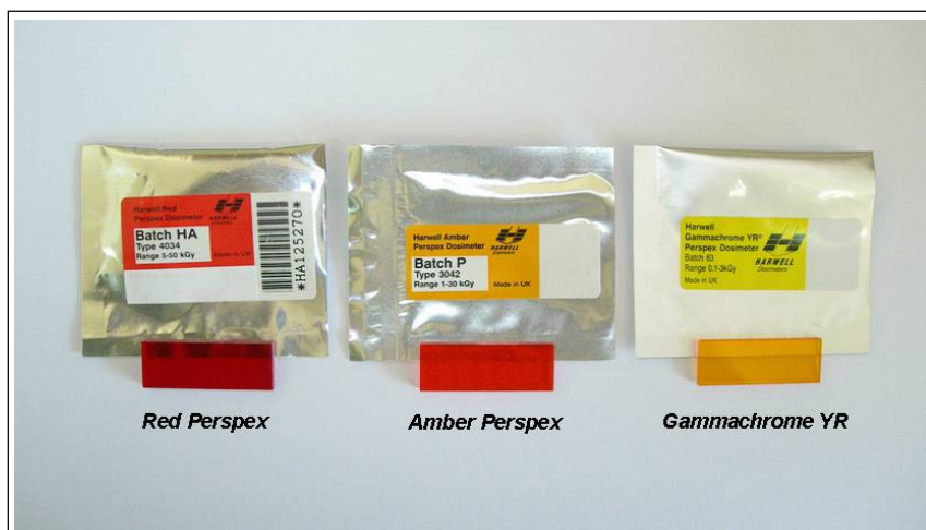
Figura 2.13: Dosímetros do tipo Red Perspex , Amber Perspex e Gammachrome YR , fabricados pela Harwell Dosimeters Ltd , utilizados nos estudos dosimétricos.
