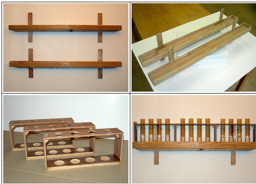
Figura 2.11: Estruturas suporte (para suspensão sobre a rede de protecção do irradiador) e porta-amostras utilizadas na primeira fase das irradiações.
