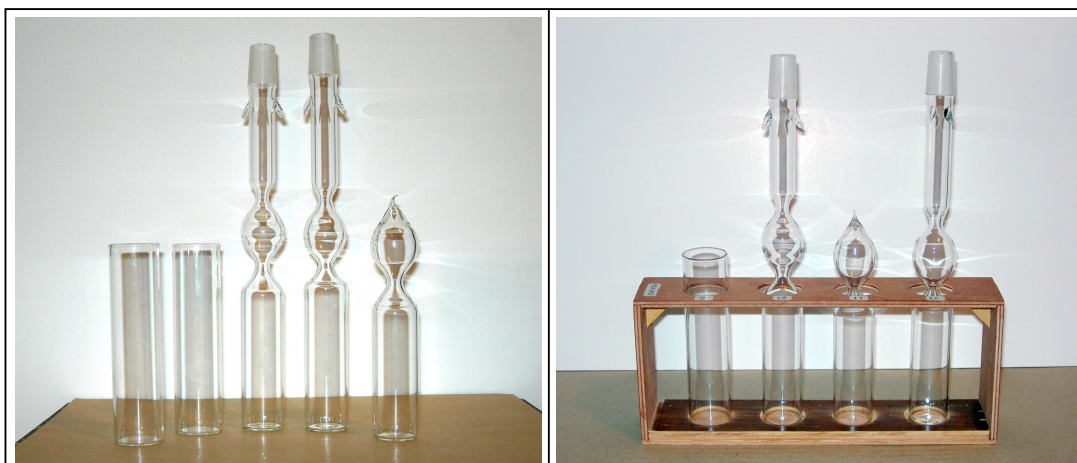
Figura 2.8: Ampolas em pyrex para irradiação das amostras em atmosfera normal e em atmosfera rarefeita.
