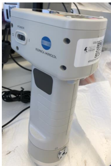
Figura 14 - Colorímetro portátil utilizado para efetuar medições de saturação, tonalidade e luminosidade de cada amostra colhida.
