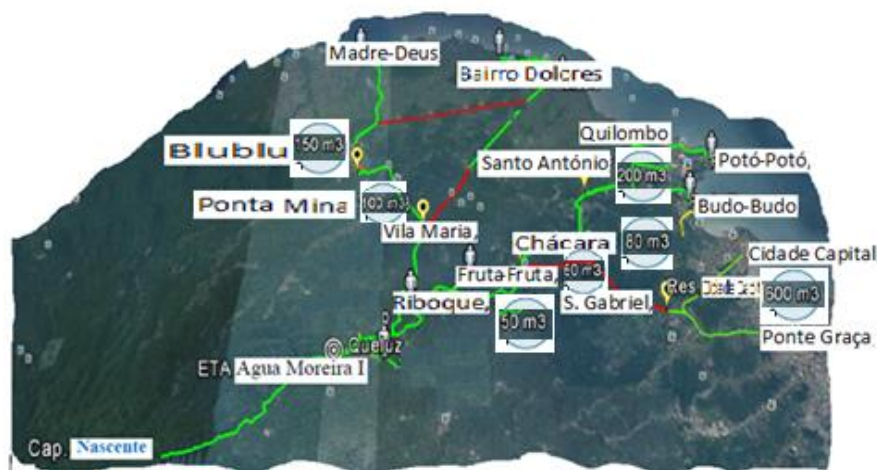
Figura 21: Captação em nascente, sistema de distribuição e respetivos reservatórios (Adaptado de Gomes, 2016).
