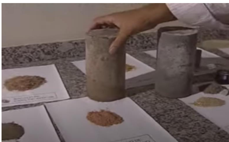
Fig. 15 | Betão Ecológico à esquerda, e betão normal à direita.
