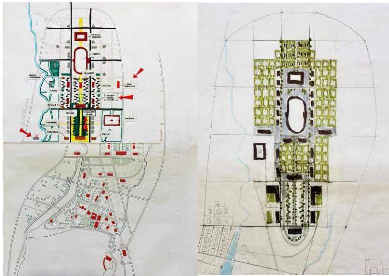
Estudo de uma malha ortogonal e disposição de equipamentos e serviços, centro de transportes e bairro comunitário.
