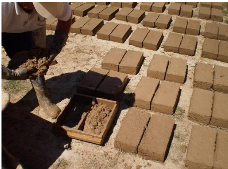
Fig. 14 | Processo de compressão da terra em moldes de madeira – BTC
