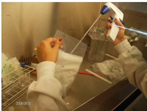
Figura 14 – Contaminação das saladas em câmara de fluxo laminar
