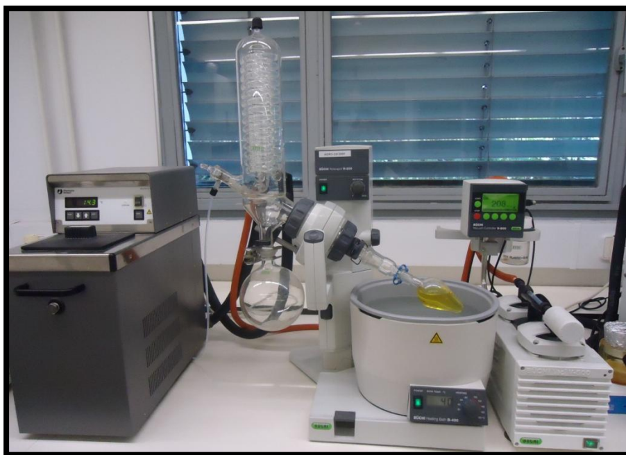
Figura 5 – Evaporação no n -hexano num evaporador rotativo de vácuo.
