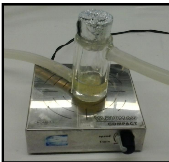
Figura 8 – Reator cilíndrico de vidro de parede dupla (25 cm 3 ) sob agitação magnética.
