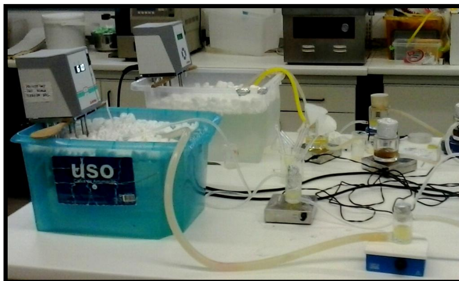
Figura 9 – Reatores em série aquecidos por banho termostatizado.
