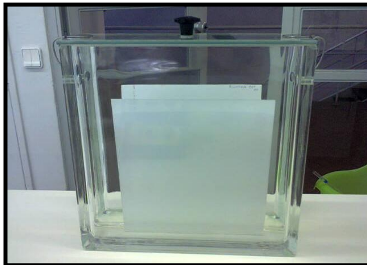
Figura 13 – Placas em tina cromatográfica.
