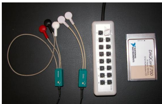
Figura 7 - Eléctrodos bipolares pré amplificados, caixa de conexão e DaqCard TM
