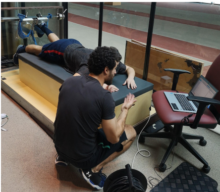
Figura 3. Dispositivo feito à medida para avaliar a taxa de produção de força na posição de decúbito ventral com dinamometria fixa. Realização do teste (A) unilateral e (B) bilateral.
