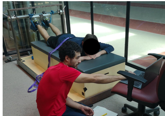
Figura 3. Dispositivo feito à medida para avaliar a taxa de produção de força na posição de decúbito ventral com dinamometria fixa. Realização do teste (A) unilateral e (B) bilateral.
