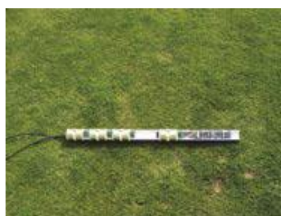
Figura 31 – Sonda de monitorização da humidade do solo (Fonte: Rebelo e Rebelo, 2009).
