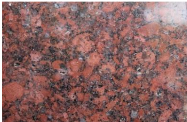
Figura 76 - Granito vermelho italiano – NCS S 5040-Y80R, existente na fachada do Piso 1 © Joana Galante, 2023
