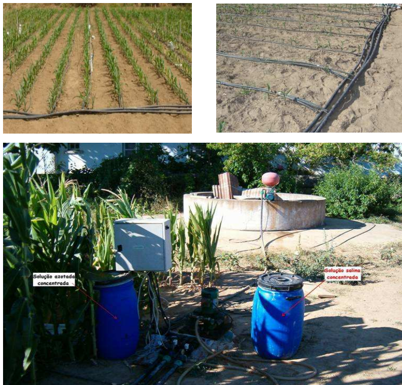
Figura 3.4 Vistas dos ensaios em Fonte Tripla Linear. Em baixo, os 2 reservatórios com soluções stock de água salina e fertilizante azotado.
