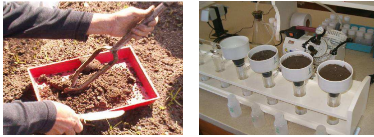
Figura 3.8 Amostragem do solo (esq.) e extracção da solução de pasta de solo saturada em laboratório (dir.) para monitorização da CEe , SAR e ESP no extracto de saturação
