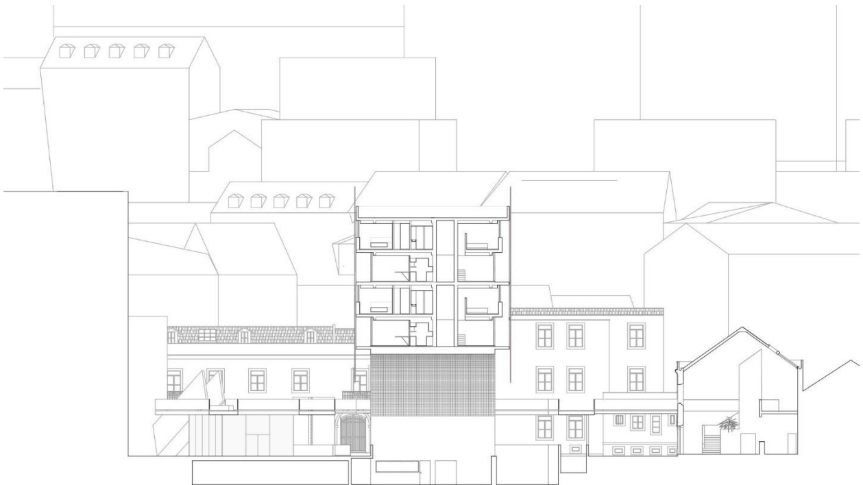
55. Edifício B | Corte transversal a passar na grande abóbada e nos elementos de betão, até chegar aos pisos de habitação, erguidos em CLT | sem escala.
