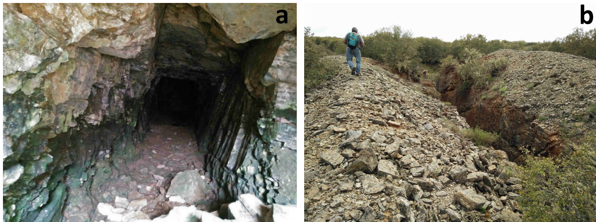
Figura 3.2. Fotografias tiradas perto da estação 3 do sector de Alimonde; a - galeria de prospecção/exploração abandonada; b - escombreira associada a uma antiga exploração de pequena dimensão ou local de prospecção.
