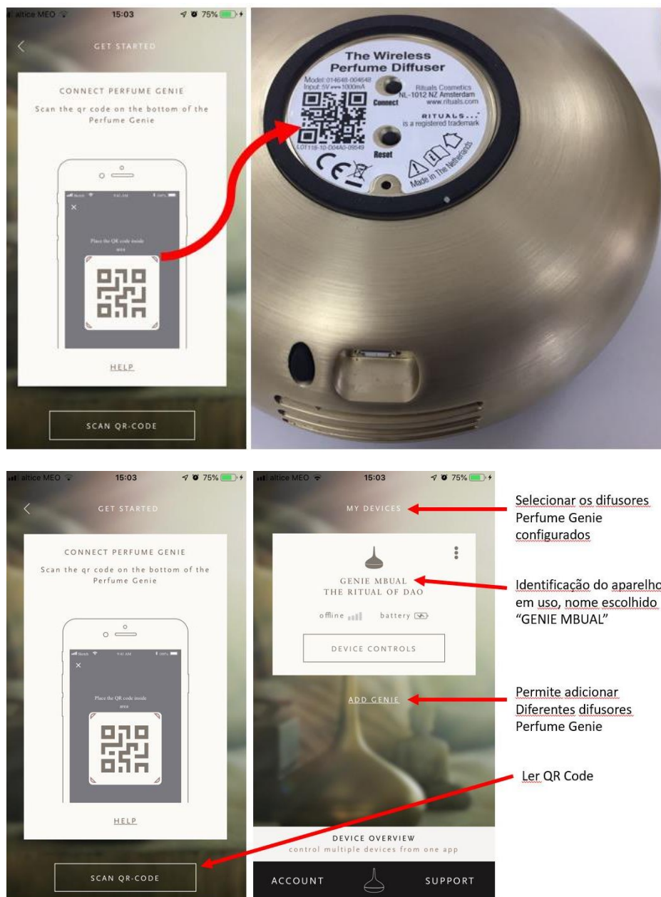
Figura 102 – Perfume Genie : conectividade e ativação do sistema
