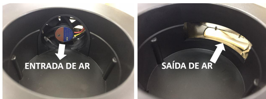
Figura 98 – Orifício para a recargas, vista da ventoinha para entrada de ar forçado e vista oposta com orifício para saída de ar no difusor Perfume Genie
