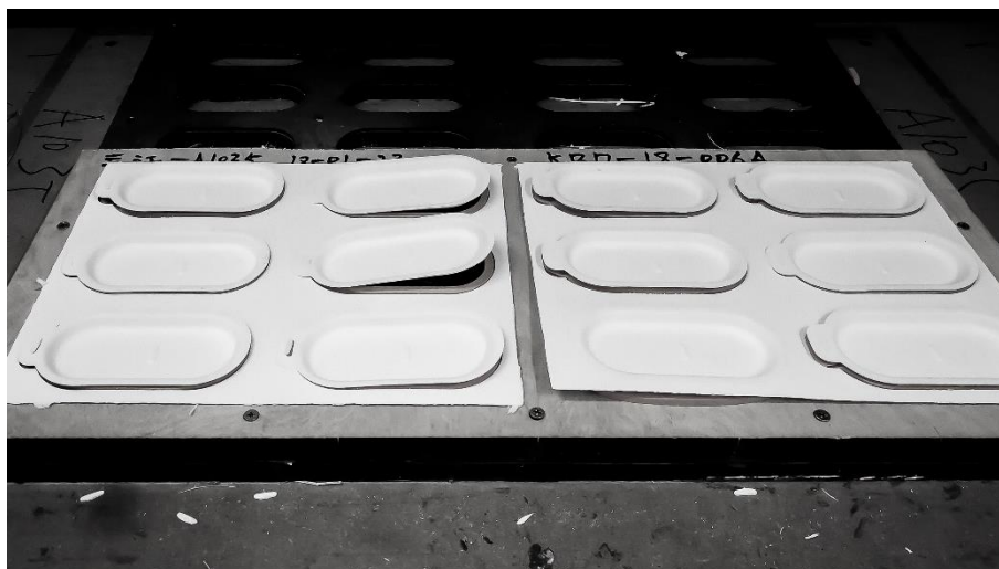
Figura 63 – Peças do ambientador Olite moldadas em pasta de papel
