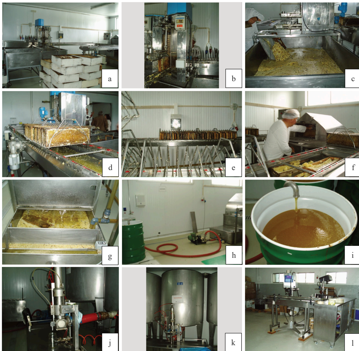
Figura 10 – Linha semiautomática de extração: (a) Alças a desopercular; (b-c) Desoperculador; (d-e) Tapete de alimentação ao centrifugador; (f) Centrifugador de eixo horizontal; (g) Tina de decantação; (h) Bomba; (i) Depósito; (j-k) Decantador com doseador para enfrascamento; (l) Rotulagem.
