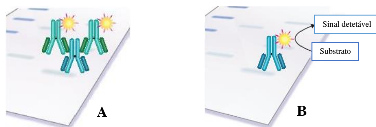
Figura 3.3 [A] Detecção por anticorpo indireta. A detecção indireta usa um anticorpo primário não marcado seguido por anticorpos secundários marcados 531 . [B] Detecção de sinal do anticorpo. O marcador do anticorpo é exposto ao substrato, criando uma banda visível na superfície do blot (substrato colorimétrico) ou como emissão de luz (substrato ECL) capturada por dispositivos adequados 532 .
