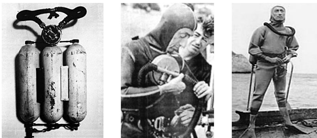
Figura 64 – Equipamento desenvolvido por Jacques Cousteau; da esquerda para a direita: sistema de ar comprimido Aqua-Lung (1942), fato de mergulho e barbatanas.
