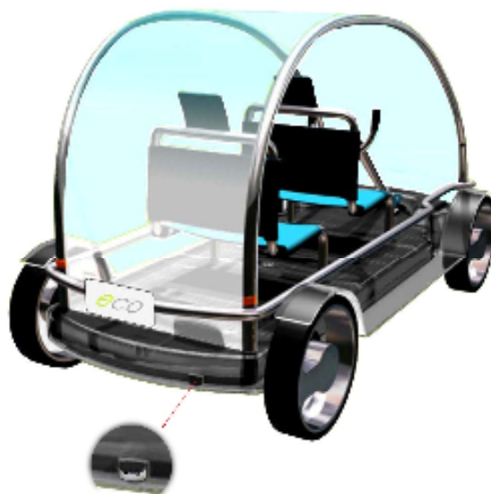
Figura 143 – EcoCar , vista posterior com pormenor da ficha de ligação à rede eléctrica.
