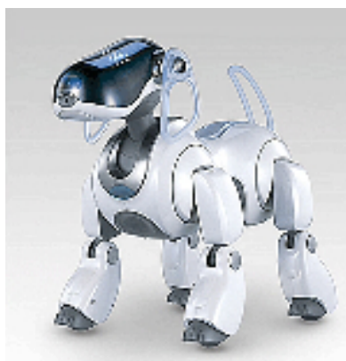
Figura 130 – Sony Aibo (1999), cão-robot capaz de interagir com os donos.
