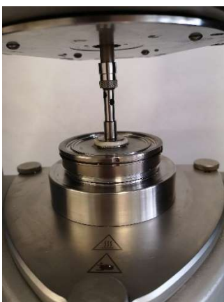
Figura 2 - Amostra durante o processo de testes no reômetro (Mars III, Haake, Alemanha), acoplado com sistema de pratos paralelos serrados PP20 (20 mm de diâmetro) com uma distância entre pratos de 1,5 mm.
