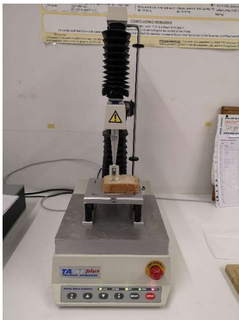
Figura 3 – Texturómetro TA.XT.Plus (Stable Micro Systems, UK) no decorrer de um teste texture profile analysis a uma fatia de pão.
