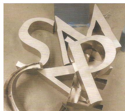
Apêndice 11. Conjunto de letras em aço inoxidável cortadas com uma altura de 0,80 metros.
