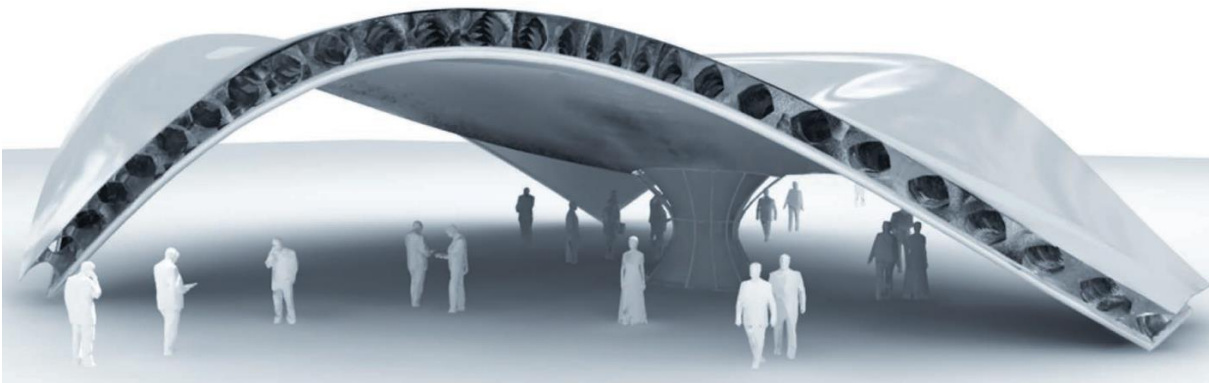
Figura 51 - Estrutura desenhada pelo arquiteto Andres Harris utilizando os mesmos princípios da estrutura óssea de uma ave, imagem de Andres Harris, 2016.
