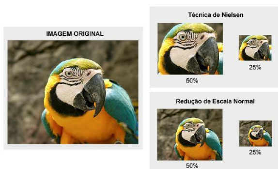
Figura 12 - Comparativo de redução de escala normal com a técnica de NIELSEN (Fonte: MEMÓRIA, 2005, P.84)
