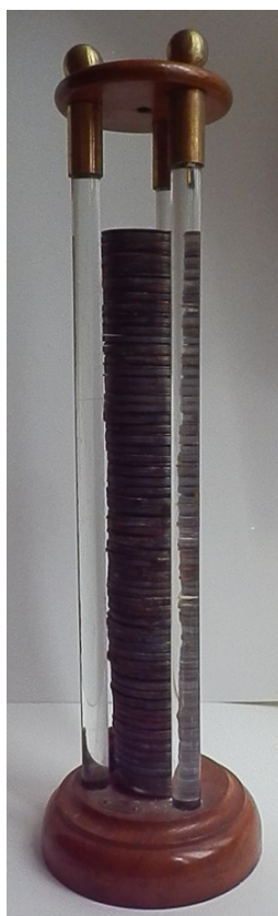
Figura 53. Pilha de Volta. Disponível no espólio de instrumentos científicos e didáticos da ESELx. Fonte: Autor.
