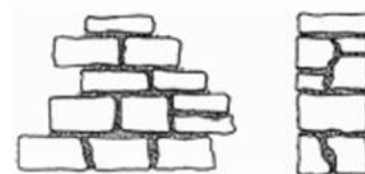
Imagem 57 | Fig. Parede de alvenaria de pedra aparelhada
