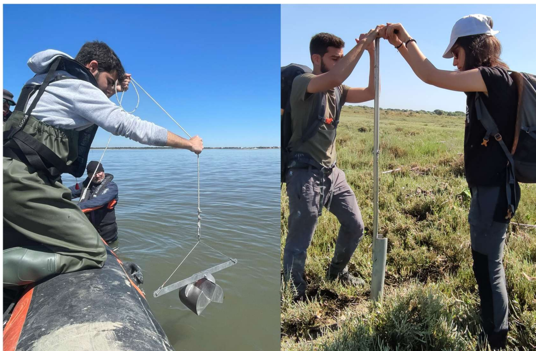
Figura 26 | Manuseamento da draga do tipo Van-Veen (à esquerda), e do corer (à direita).
