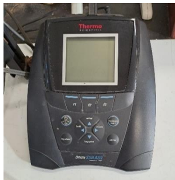
Figura 20 - Condutímetro Orion Star A212 Thermo Scientific
