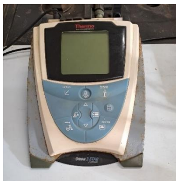
Figura 19 - Potenciômetro Orion 3 Star Thermo Scientific
