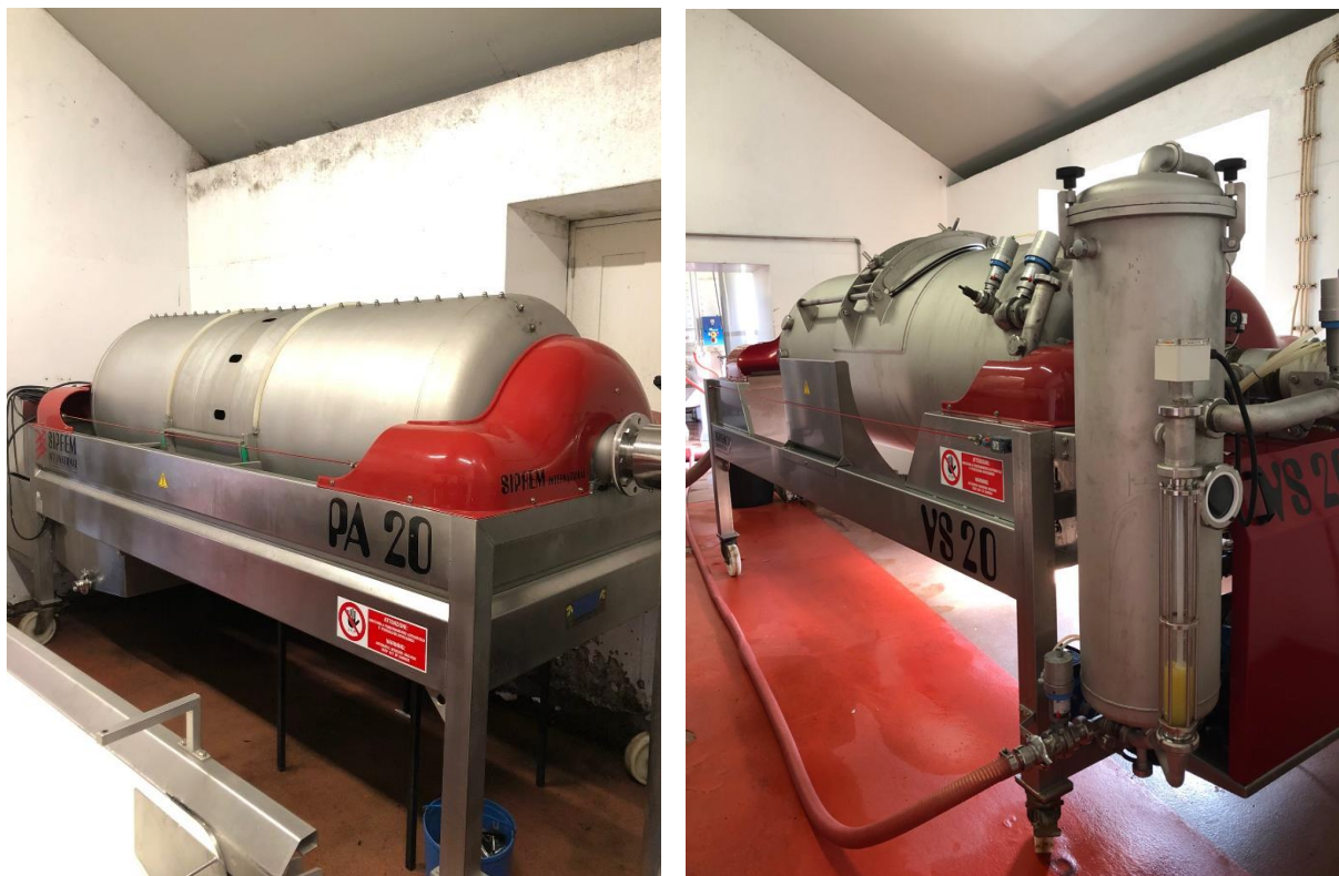
Figura 24- Prensa horizontal pneumática de pressão (à esquerda) e prensa horizontal pneumática de vácuo (à direita).
