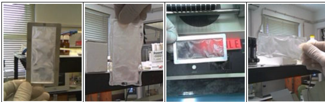
Figura 5.10: Filmes PE- g -HEMA obtidos na 2ª série de ensaios de optimização de preparação dos filmes copoliméricos.
