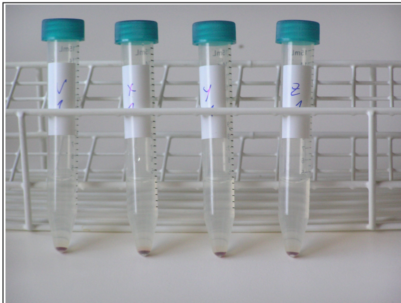
Figura 5.53: Amostras de filmes PE-g-HEMA durante o teste de hemólise: Tubo V : filme com 397% ( t_{\text{irrad}}= 30 h); Tubo X : filme com 276% ( t_{\text{irrad}}= 25 h); Tubo Y : filme com 165% ( t_{\text{irrad}}= 40 h); Tubo Z : filme com 168% ( t_{\text{irrad}}= 35 h).
