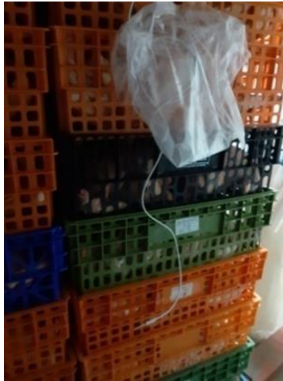
Figura 4 - Monitorização da temperatura de carcaças de galinha, com data logger durante o processo de congelação em túnel.
