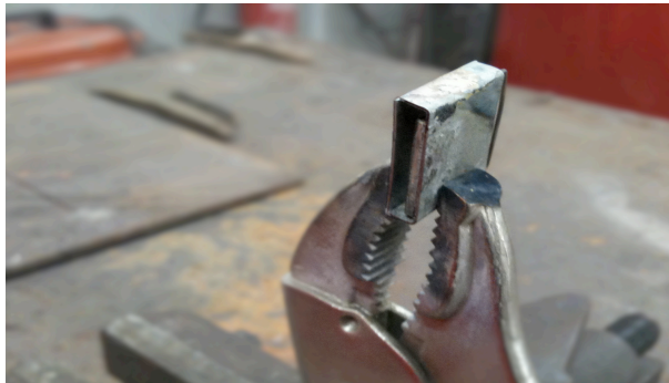
Fig. 49 – caixa fechada (revestida a chapa metálica)
