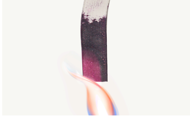
Fig. 54 – Reacção química do verniz termocromático ao calor
