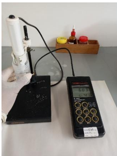
Figura 4: Potenciômetro HANNA utilizado para medir o potencial hidrogeniônico (pH).
