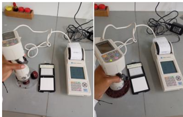
Figura 6: Colorímetro CR-400 (Minolta, Japão) utilizado para medir a cor dos enchidos.
