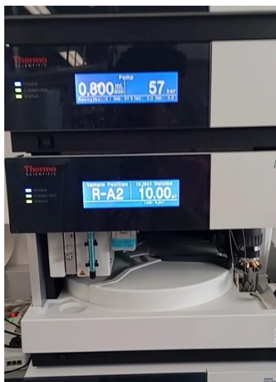
Figura 7: Cromatógrafo líquido de alta pressão utilizado para a determinação das aminas biogénicas.
