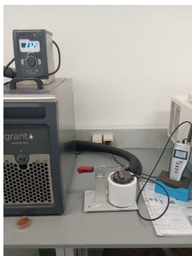
Figura 5: Higroscópio Rotronic HygroPalm utilizado para medir a atividade da água ( a_w ).
