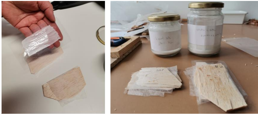
Figura 57- Testagem da camada de sacrifício mediante o método com papel melinex não siliconado (©Rafaela Santos, 2022).
