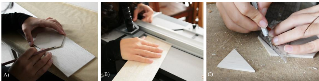
Figura 55 – Processo de corte dos hexágonos. A) Delineação do molde de hexágono nas tábuas de balsa. B) Recorte com a guilhotina. C) Recorte das arestas com o bisturi (©Rafaela Santos, 2022).
