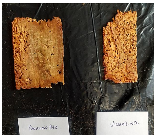
Figura 47- Amostras do suporte original em que se testou os diferentes adesivos (©Rafaela Santos, 2021).
