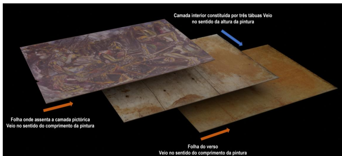
Figura 24- Representação da técnica construtiva do suporte, modelada em cenário virtual, em que é representada a folha superior do suporte onde está inserida a camada pictórica, a alma do contraplacado que corresponde ao seu interior e a folha anterior referente ao verso da pintura, onde se menciona a direção do veio da madeira em cada camada. (© Aquisição fotográfica por Frederico Henriques e Rafaela Santos e exercício de computação gráfica por Rafaela Santos, 2021).
