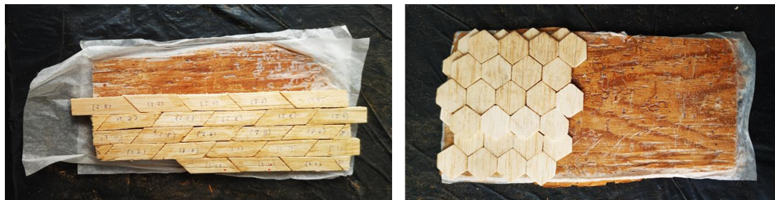
Figura 52- Maquetes onde foram testados os diferentes formatos geométricos para a reconstrução da camada intermédia. A) Formato retangular. B) Formato hexagonal (©Rafaela Santos, 2022).
