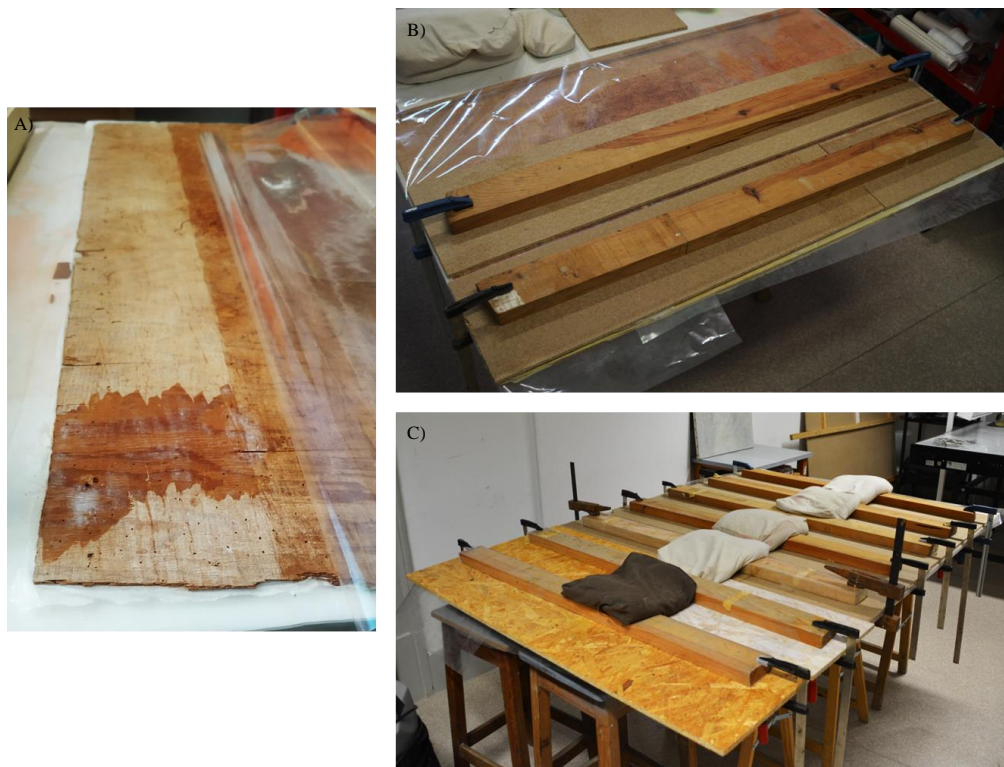
Figura 49- Demonstração do processo de consolidação e planificação. A) Processo de aplicação do adesivo numa faixa designada para posterior cobertura com tábuas de madeira e reforçada com grampos metálicos, como podemos visualizar nas imagens B e C (©Rafaela Santos, 2022).
