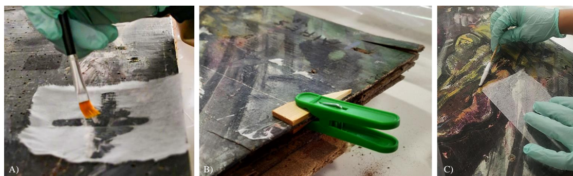
Figura 41- Zona de testagem dos adesivos nas zonas de fenda e processo de remoção das áreas testadas. A) Aplicação do adesivo. B) Fixação da zona de fenda durante a secagem do adesivo. C) Remoção do adesivo (©Rafaela Santos, 2021).
