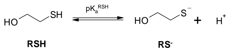
Esquema 3.1 – Equilíbrio ácido-base para o 2-mercaptoetanol.
