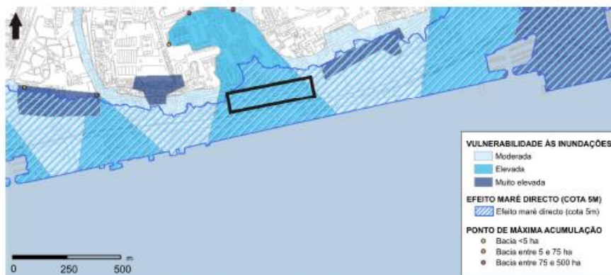
Figura 4.2 – Carta de Vulnerabilidade às inundações Fonte: Proposta de revisão do PDM de Lisboa (2009)
