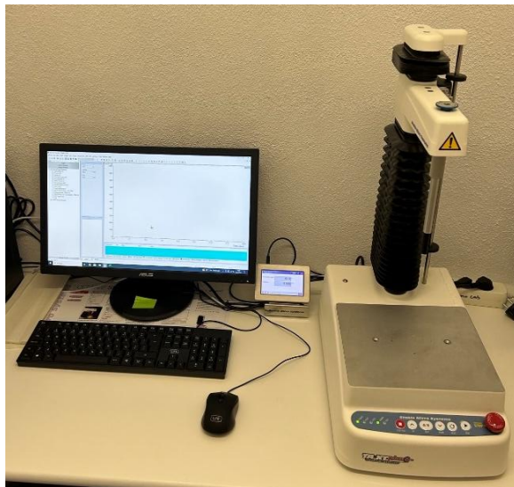
Figura 14. Texturómetro TA.XTplusC: (A) analisador de texturas e (B) sonda cilíndrica de 10 mm de diâmetro.
