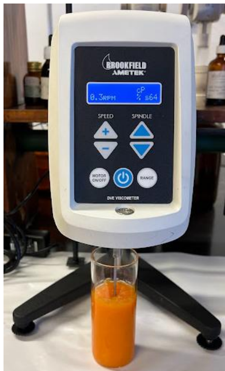
Figura 13. Teste de viscosidade para amostra de abóbora-manteiga com agulha Brookfield LV-64.
