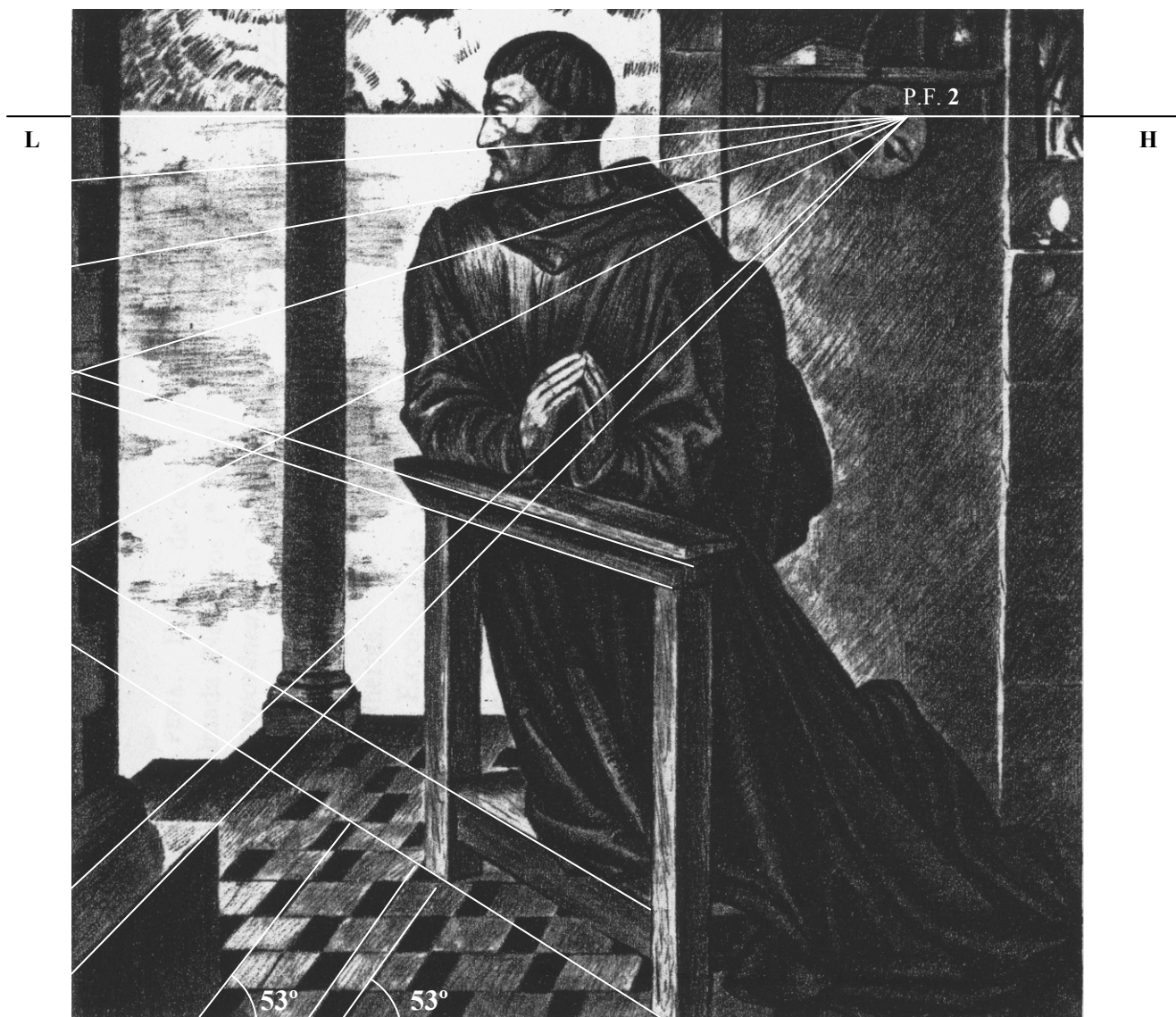
Figura 169 - Esquema dos sistemas de representação existentes (perspectiva linear e perspectiva axonométrica oblíqua (com ângulo de fuga de 53^\circ ).
